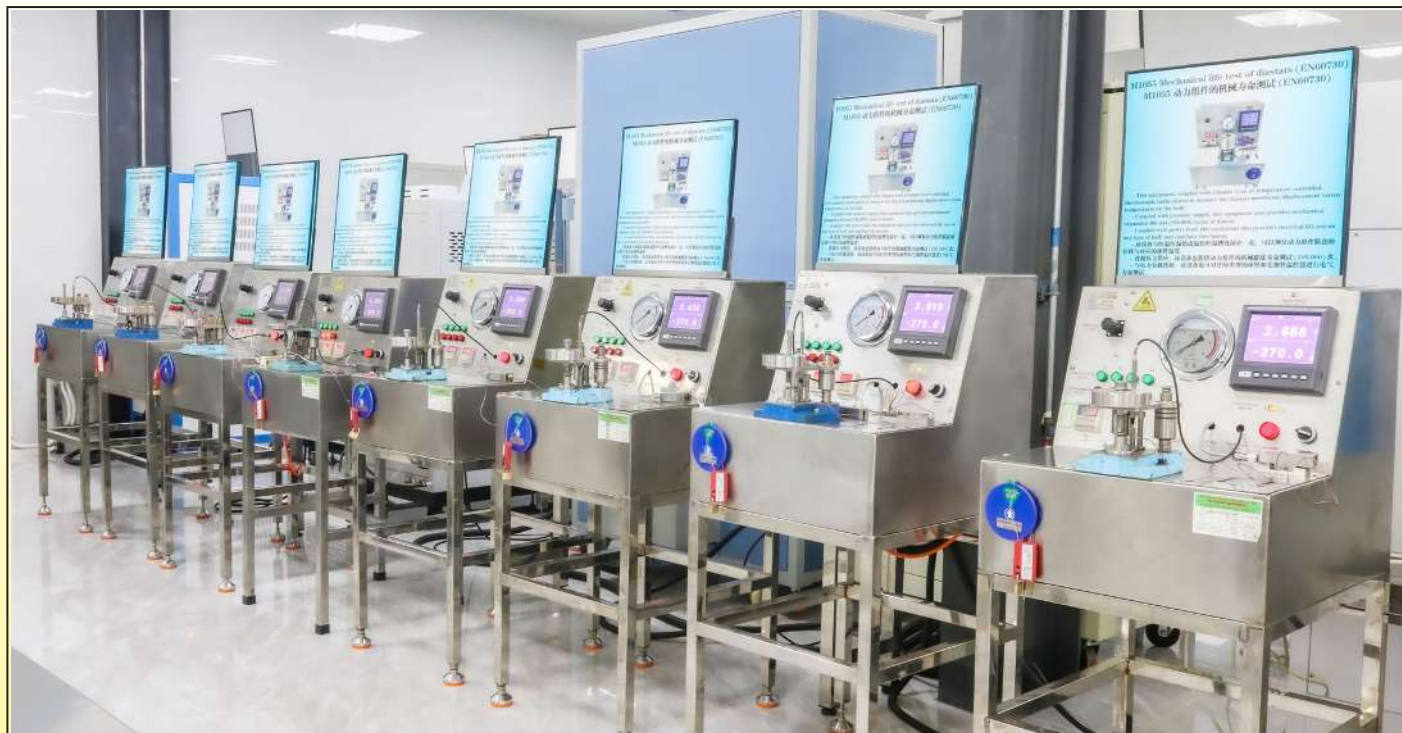
Комплект автоматического оборудования для механического испытания диастатов на долговечность. Каждое оборудование оснащено регистратором параметров испытания и количества циклов. (Лаборатория Ultimheat).
